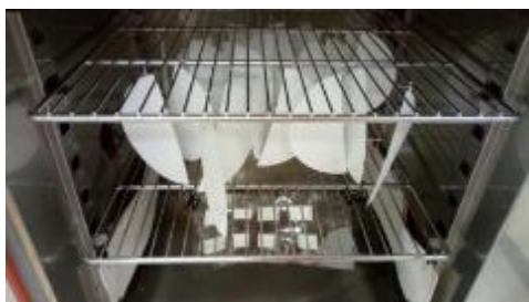
圖 8.可程式恆溫恆濕試驗機
