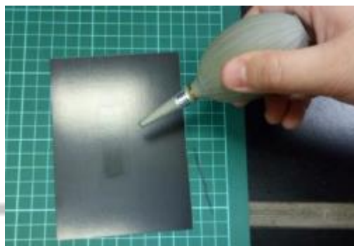
圖 3..西卡紙樣本製作 4.定性濾紙樣本製作 5. 使用空氣球清潔 10 次
