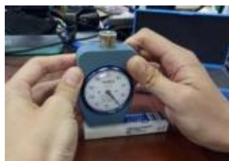
圖 15. TECLOCK GS709N 硬度計
